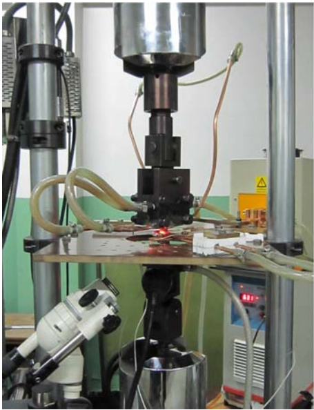
图 1 单晶涡轮叶片 TMF 试验
